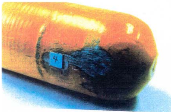
ب - آسیب ساییدگی سطح ۲ - عمق سایش بین ۵٪ تا ۱۵٪ ضخامت است (سیلندر تمام پیچ شده)
