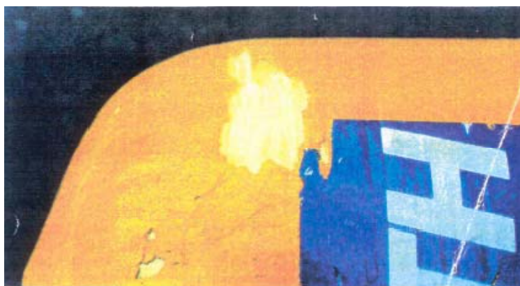
پ - آسیب ساییدگی سطح ۳ - سایش شدید بیش از ۱۵٪ ضخامت
