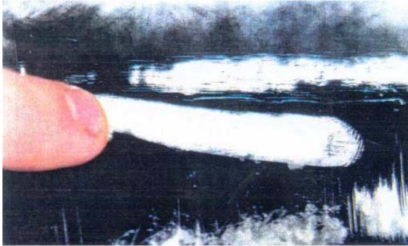
الف - آسیب ناشی از شعله سطح ۱- فقط زغالی شدن سطحی
